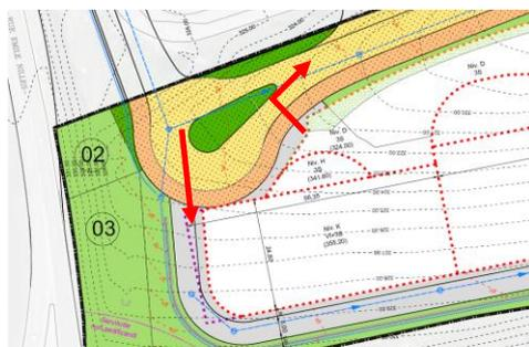
Figure 21 : Schéma de principe d'entrée/sortie carrossable à l'ouest (Source : BEST)
