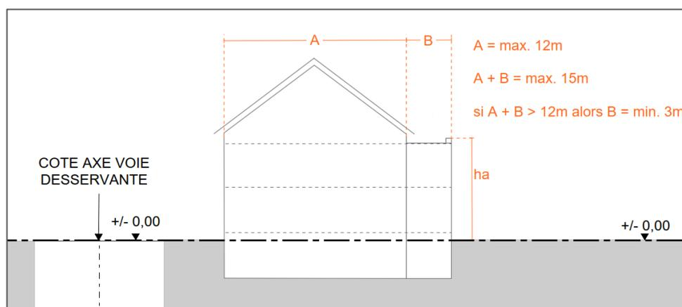
Figure 3.24.1. Dimension maximale des toitures en bâtière
