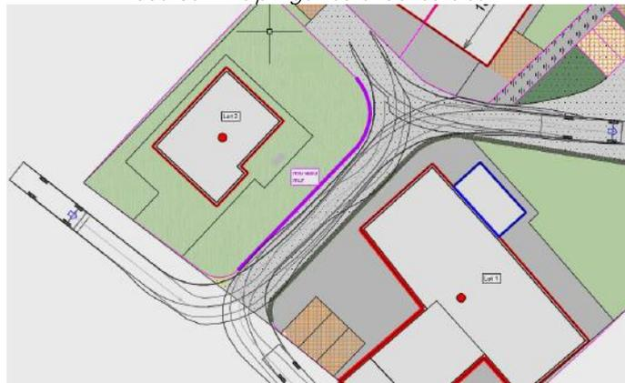
Figure 21 : Epure de giration d'un camion poubelle Pusher 4000,
