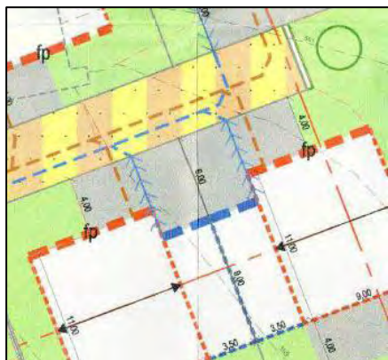
Figure 10 : extrait de la vue en plan (hors échelle) à hauteur des lots n°3a et 4a illustrant le principe d'évacuation des eaux pluviales à l'avant des constructions dans le PAP en vigueur
