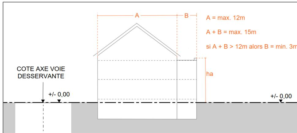
Figure 1.24.1 Dimension maximale des toitures en bâtière
